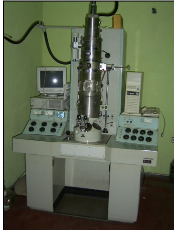
Фиг. 2.12. Трансмисионен електронен микроскоп УЕМ-100Л
