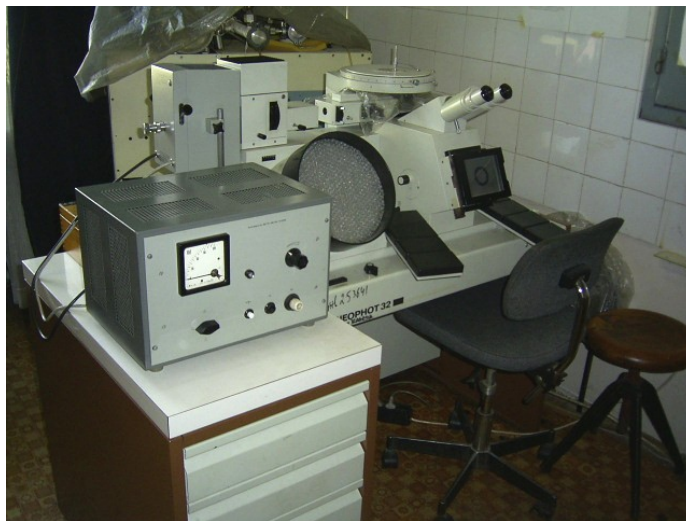
Фиг. 2.11. Металографски микроскоп
