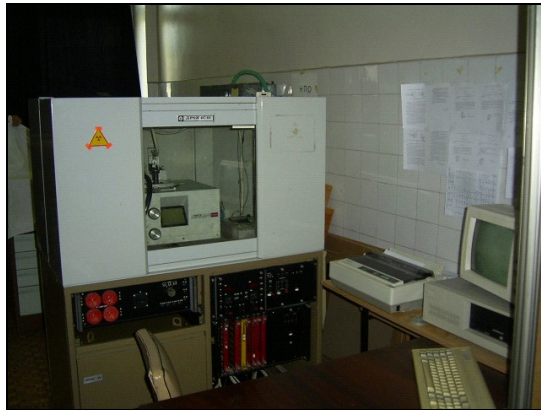
Фиг. 2. 6. Рентгенов дифрактометър ДРОН 1
